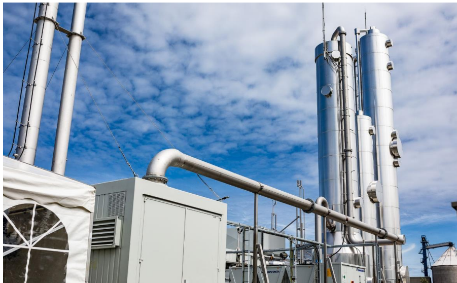
Foto. Kunda projekti puhul saab toorbiogaasist biometaan läbi vesipesu puhastustehnoloogia (Postimees)
